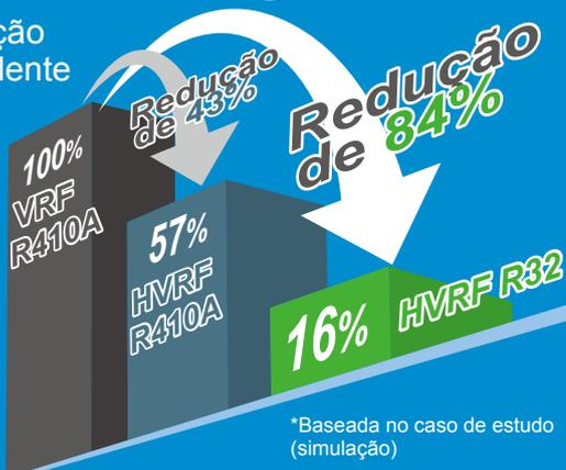
A combinação do sistema HVRF com R32 permitiu obter uma grande redução no equivalente CO<sub>2</sub>. O objectivo da Mitsubishi Electric é suprimir o aquecimento global com o novo sistema de ar condicionado amigo do meio ambiente.
